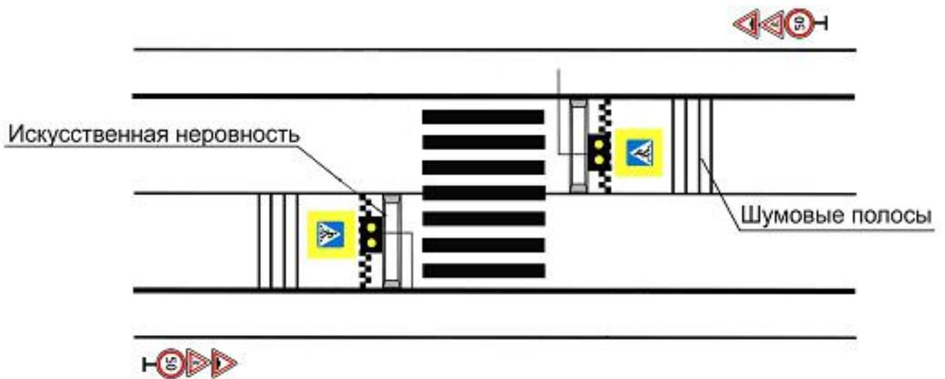
Рисунок Б.5 - Устройство искусственных неровностей
