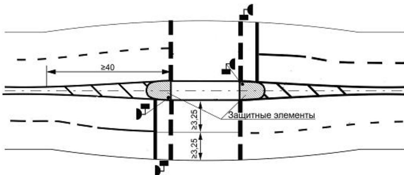
Рисунок Б.6 - Устройство островка безопасности
