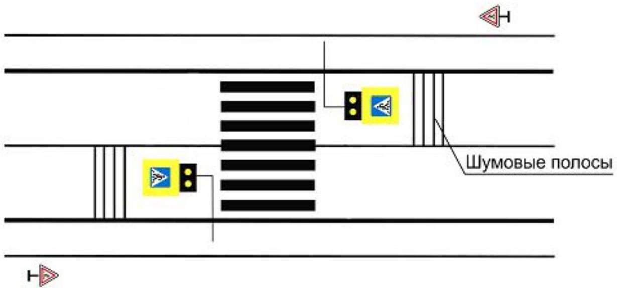
Рисунок Б.4 - Устройство шумовых полос
