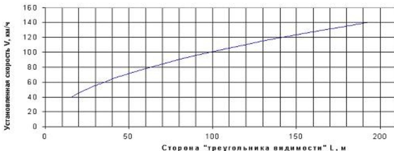
Рисунок 2 - Определение стороны "треугольника видимости" для транспорта L
