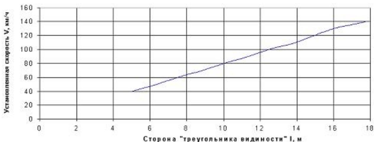
Рисунок 3 - Определение стороны "треугольника видимости" для пешехода l
